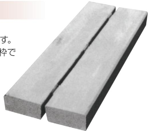
規格及び荷重用途はJISA5345道路用鉄筋コンクリート側溝二種 (主として車道に平行使用、自動車荷重総重量25t、後輪荷重5t、衝撃係数10%) に準じます。
