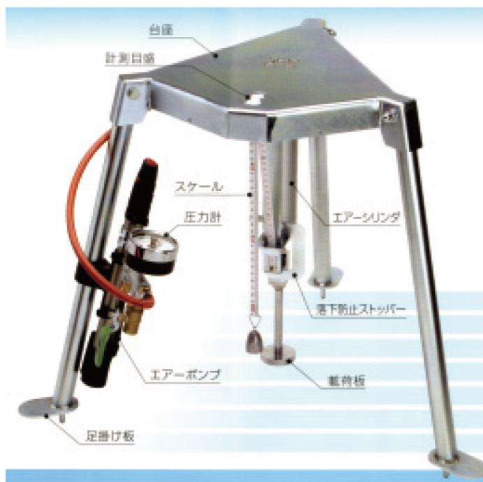
代表的な地盤の支持力を計測する試験方法には、平板載荷試験（原位置に剛な載荷板を設置して荷重を与え、この荷重の大きさと板載荷の沈下との関係から地盤の支持力特性を調べる試験 JGS1521 地盤の平板載荷試験方法）があります。しかしながら平板載荷試験に要する高額な費用や、長時間に及ぶ試験時間の問題などから、比較的小規模な土木工事や緊急を要する土木工事においては全ての現場で平板載荷試験が行われているわけではありません。
