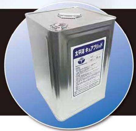
2つの有効成分を効果的に配列することにより、効率的に養生効果と耐久性を付与することができます。初期の急激な乾燥による初期ひび割れを抑制し、劣化因子からコンクリートを守るため、耐久性の高いコンクリート構造物に役立ちます。
