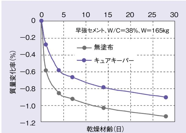
乾燥材齢28日の時点で、無塗布に比べて約2割以上の水分保持能力の増加が認められます。この保持された水分は、若材齢のセメントの水和反応に非常に有効になります。
