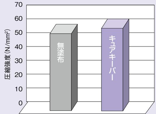
キュアキーパーを塗布したコンクリートは初期材齢の水分保持によって水和反応が進み、材齢28日において無塗布(気中養生)に比べて約1割の強度増進が認められます。
