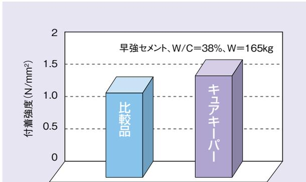
従来からパラフィン系の養生剤は、大幅な付着強さの低下が知られておりますが、キュアキーパーはパラフィン粒子形が著しく小さいため、分散性がよく従来より付着強さの改善が認められます。
